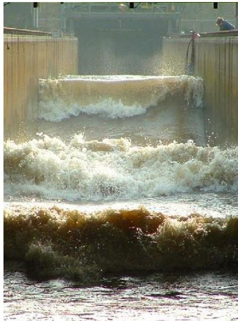
*Figure 64 : Série de vagues durant une expérience d'érosion de dune dans le canal à houle Deltaflume. Ces tests sur modèles réduits permettent de calibrer et d'améliorer les formules et les modèles. Source : Deltares.*
