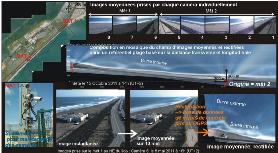
Figure 37 : Principe de fonctionnement du système fixe d'imagerie vidéo ARGUS installé sur le Lido (Gervais, 2012).
