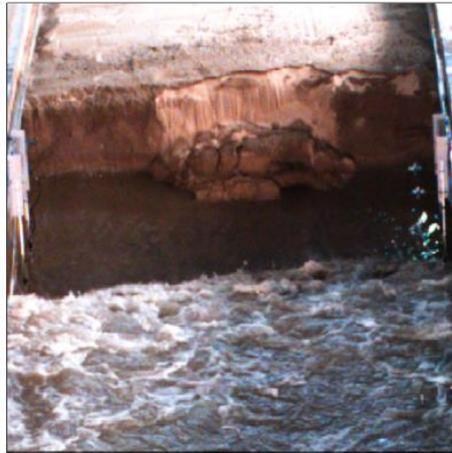
*Figure 51 : Image d'un secteur érodé d'une dune lors d'une expérience en canal à houle (Palmsten et Holman, 2011).*
