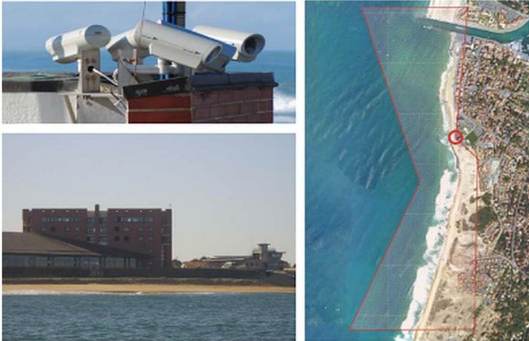
Figure 9 – Dispositif de suivi littoral par caméra vidéo sur la plage de Capbreton, Landes (<http://www.casagec.fr>)
