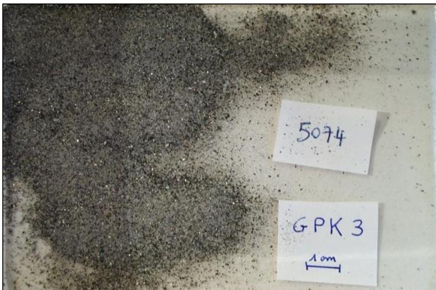
Figure 61 : Cuttings du forage GPK3, fin de passe à 5 074 m.
