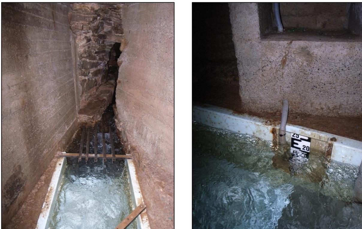
*Illustration 95 : Griffon de la source de La Glacière et dispositif de suivi de la hauteur d'eau*
