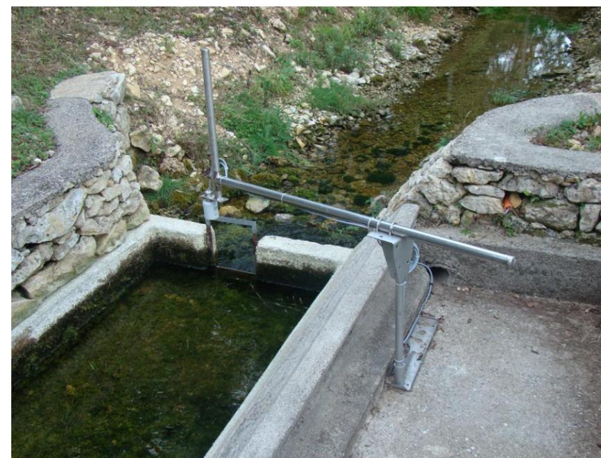
La sonde mesure donc une hauteur d'eau au-dessus de la lame déversante. Une relation simple hauteur/débit permet d'en déduire le débit alimentant la rivière. Les données sont transmises à la télégestion de la station, puis stockées sur le central de télégestion pour analyses des données.
