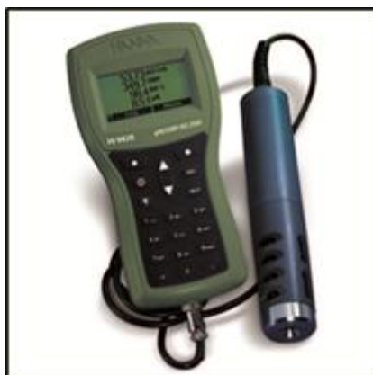
illustration 22 : Sonde multi-paramètres HANNA 9828
