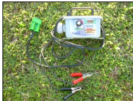
illustration 18 : pompe PowerPurge36 24V et survolteur 12/24V (marque SDEC)
