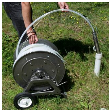
illustration 26 :Pompes Twister et Grundfos MP1 utilisées pour la campagne de prélèvement
