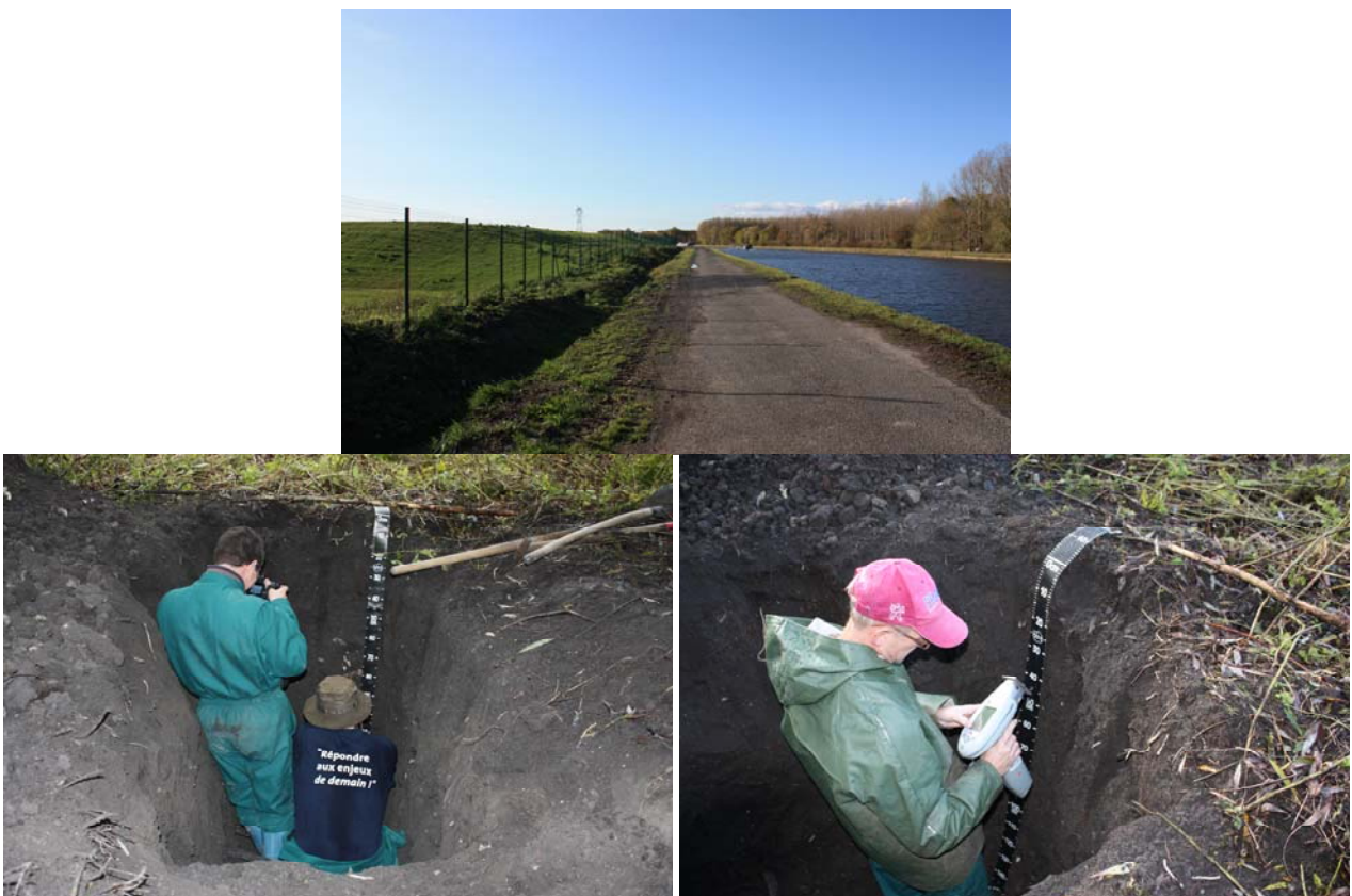
Figure 17 : Site de dépôt, relevé de fosse et suivi pXRF in situ.
