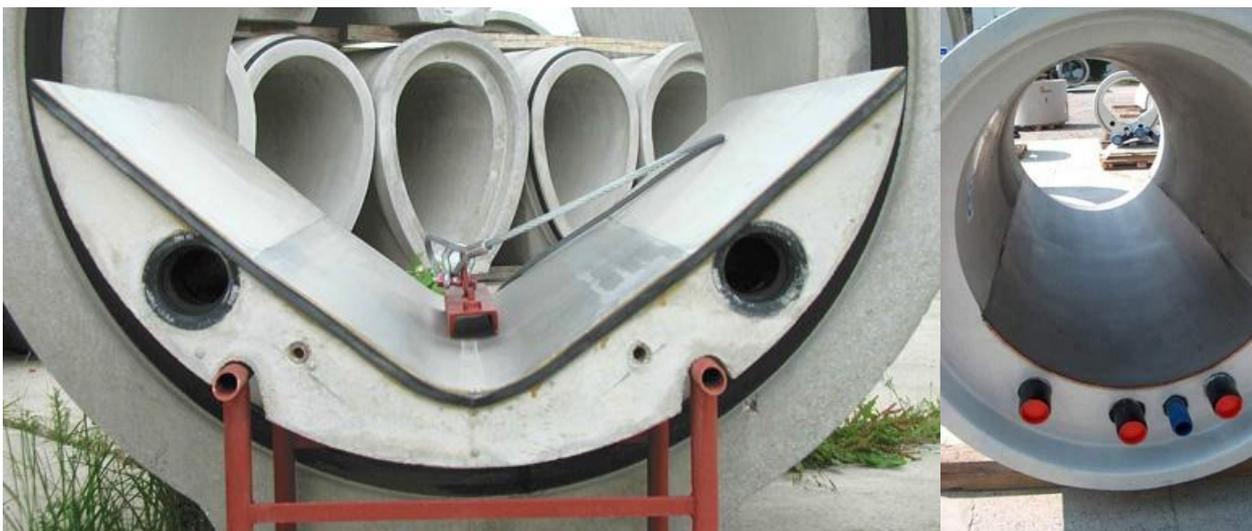
*Illustration 126 : Echangeur béton rapporté vis-à-vis d'une exécution standard (source : Rabtherm)*
