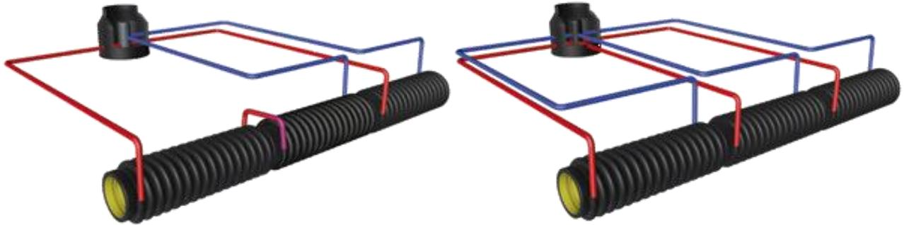
Illustration 146 : Exemples de raccordement du système ThermPipe
