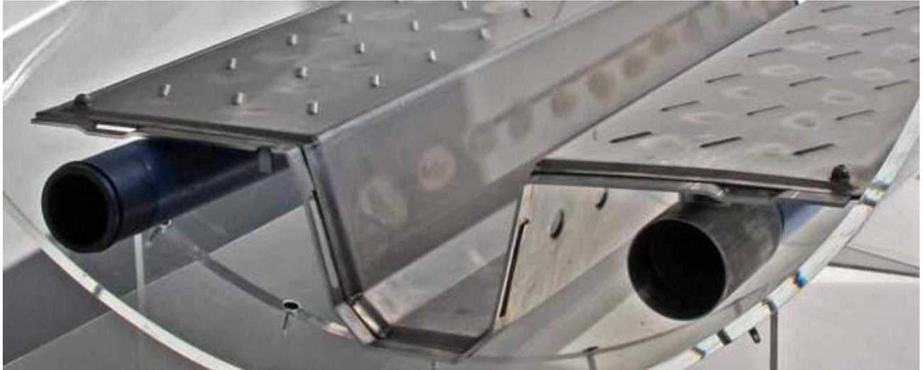
*Illustration 137 : Vue détaillée des points d'ancrage entre sections d'un échangeur*
