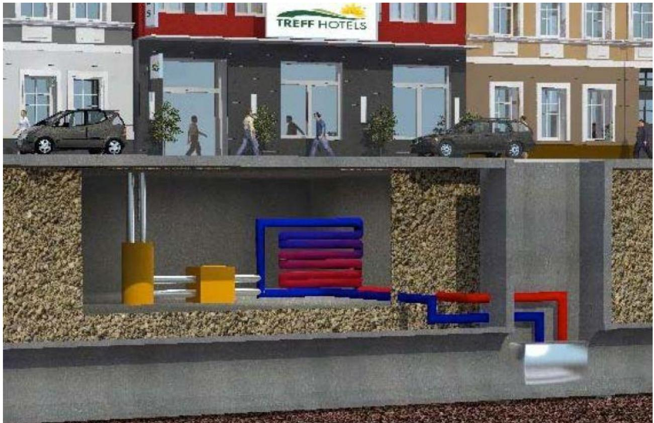
*Illustration 149 : Principe d'un dispositif en dérivation pour alimenter un immeuble*
