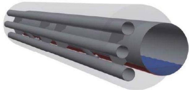
*Illustration 116 : Principe de l'échangeur de chaleur intégré dans une canalisation en béton neuve ou rénovée, écoulement gravitaire (source : KASAG)*
