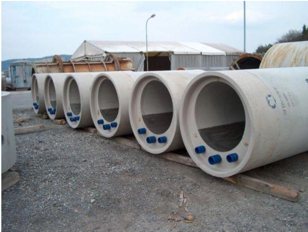
*Illustration 125 : Exemple d'exécution de canalisation gravitaire en béton (source : Rabtherm)*
