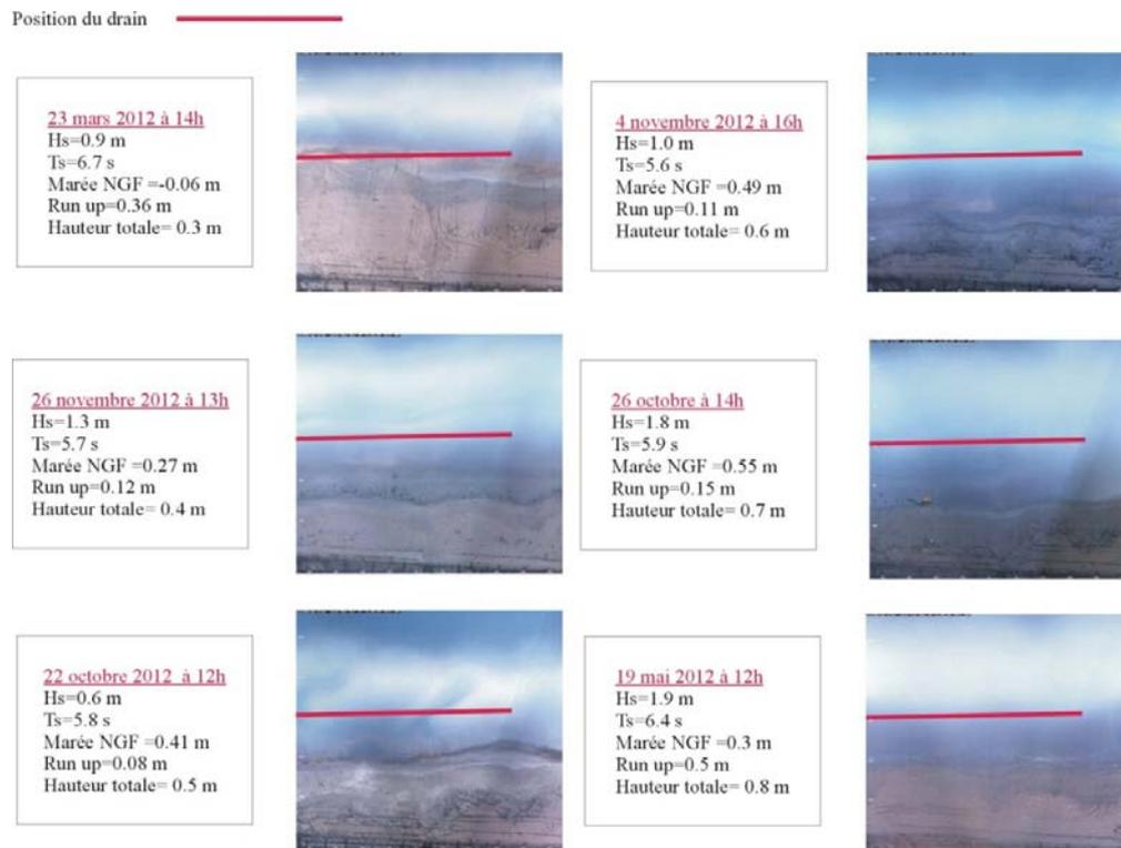
*Illustration 36 - Position du drain pour différentes conditions hydrodynamiques. On note que pour des niveaux d'eau maximaux compris entre 0.3 et 0.8 m, la zone de battement du jet de rive (en blanc) est localisée au-dessus du drain.*
