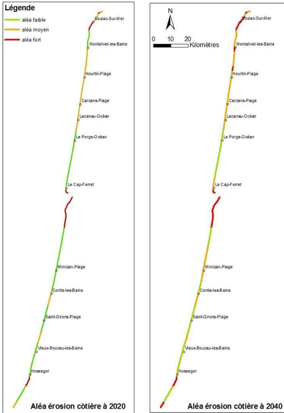
Figure 22 : Cartographie de l'aléa érosion côtière sur la côte sableuse aux horizons 2020 et 2040 (Aubié et al., 2011)
