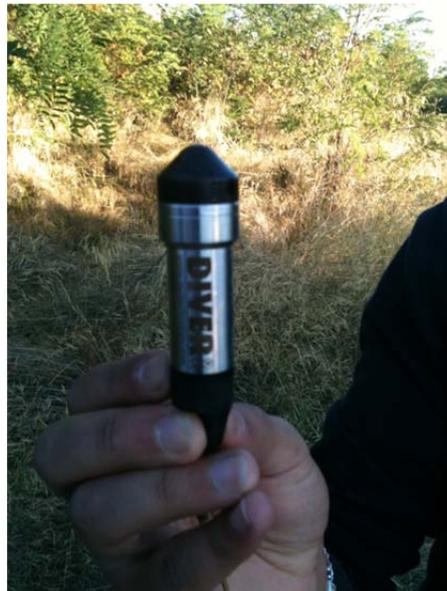
*Illustration 13 : Modèle de sonde utilisée pour la mesure, l'enregistrement et le stockage des données de température et de niveau piézométrique (mesure toutes les 10 minutes).*
