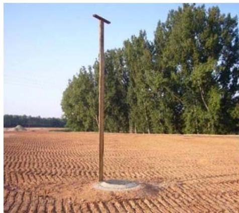
Illustration 110 - Un puits de surveillance de la nappe perchée sur le triangle de Marienau.
