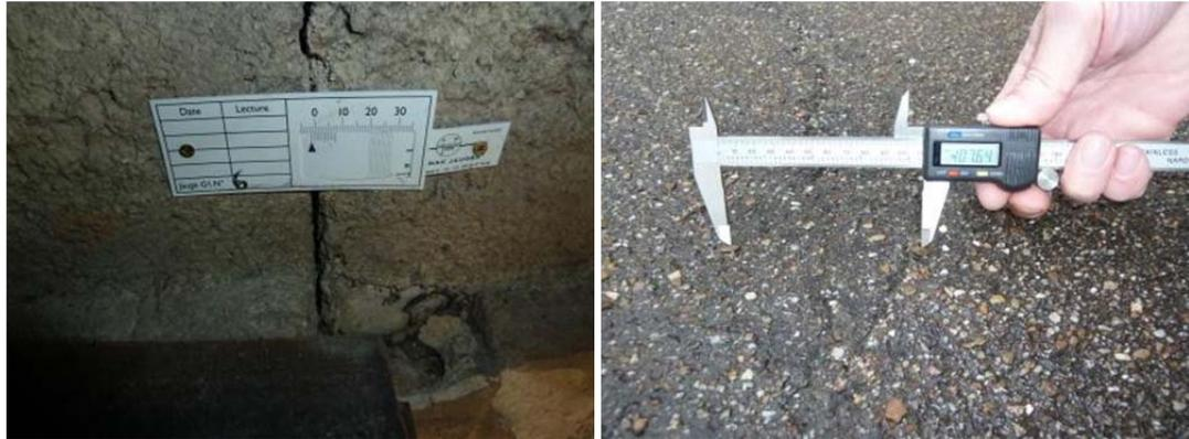
Illustration 81 - Un fissuromètre installé au mur – Surveillance d'une fissure de chaussée.
