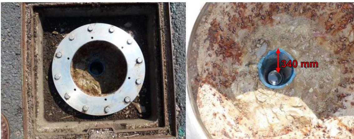
Illustration 56 - La tête du forage avec indication de mesure du niveau d'eau.
