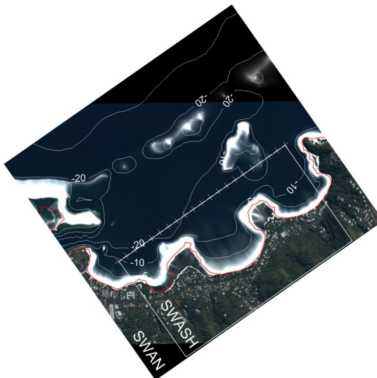
Figure 68. Emprise des modèles SWAN et SWASH. Le trait rouge indique l'isobathe 0m et les traits blancs les isobathes -20m, -10m et -5m. Les zones principales de déferlement calculées par SWAN ( 0.5 < Q_b < 1 ) sont indiquées en blanc.
