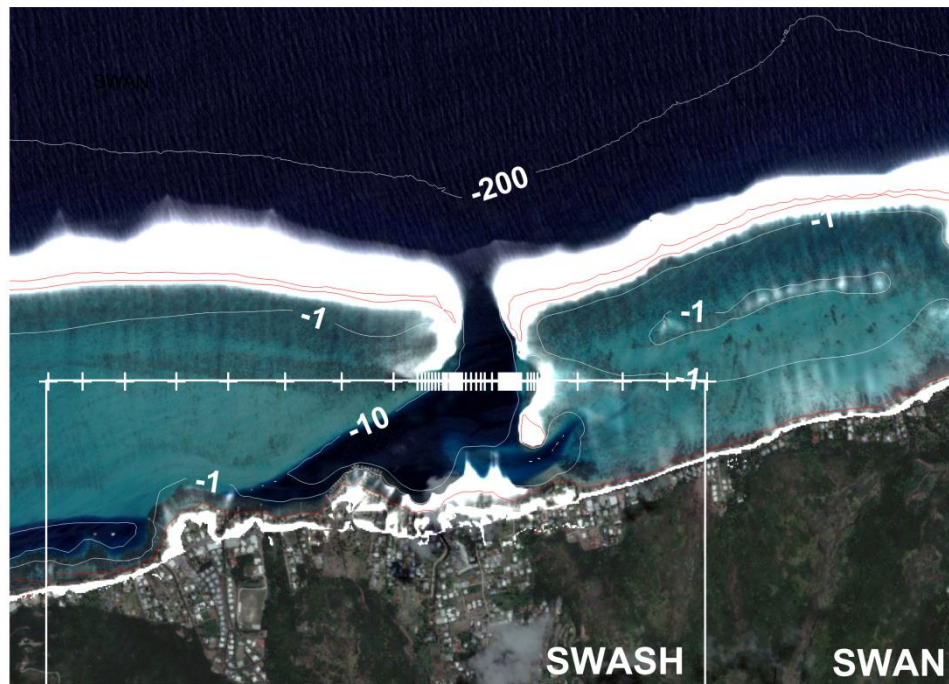
Figure 50. Emprise des modèles SWAN et SWASH. Le trait rouge indique l'isobathe 0m et les traits blancs les isobathes -200m, -1m et -10m. Les zones principales de déferlement calculées par SWAN ( 0.5 < Q_b < 1 ) sont indiquées en blanc.
