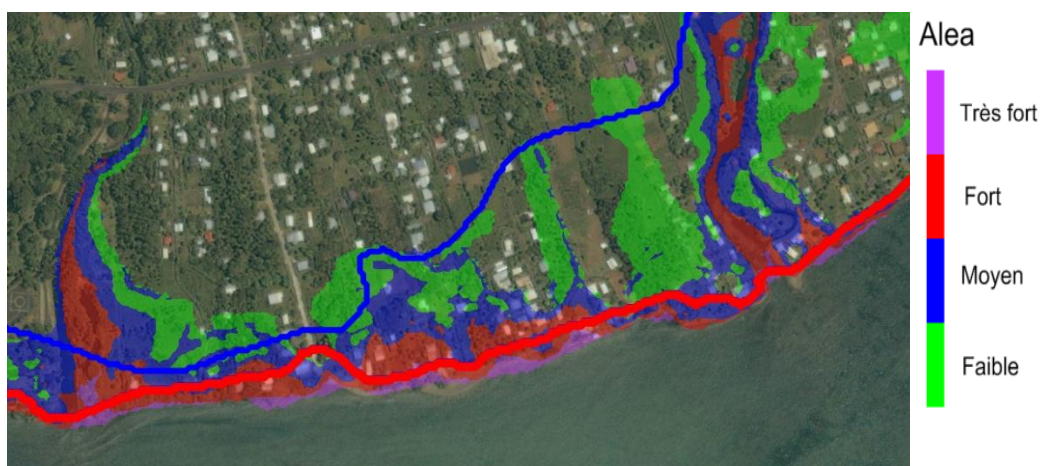
Figure 77. Extrait de la carte d'aléa submersion ARAI3 (2100) pour le site de Teva I Uta. Les contours rouge et bleu représentent les limites des zones d'aléa fort (submersion + impact des vagues) et moyen dans la cartographie d'ARAI1.
