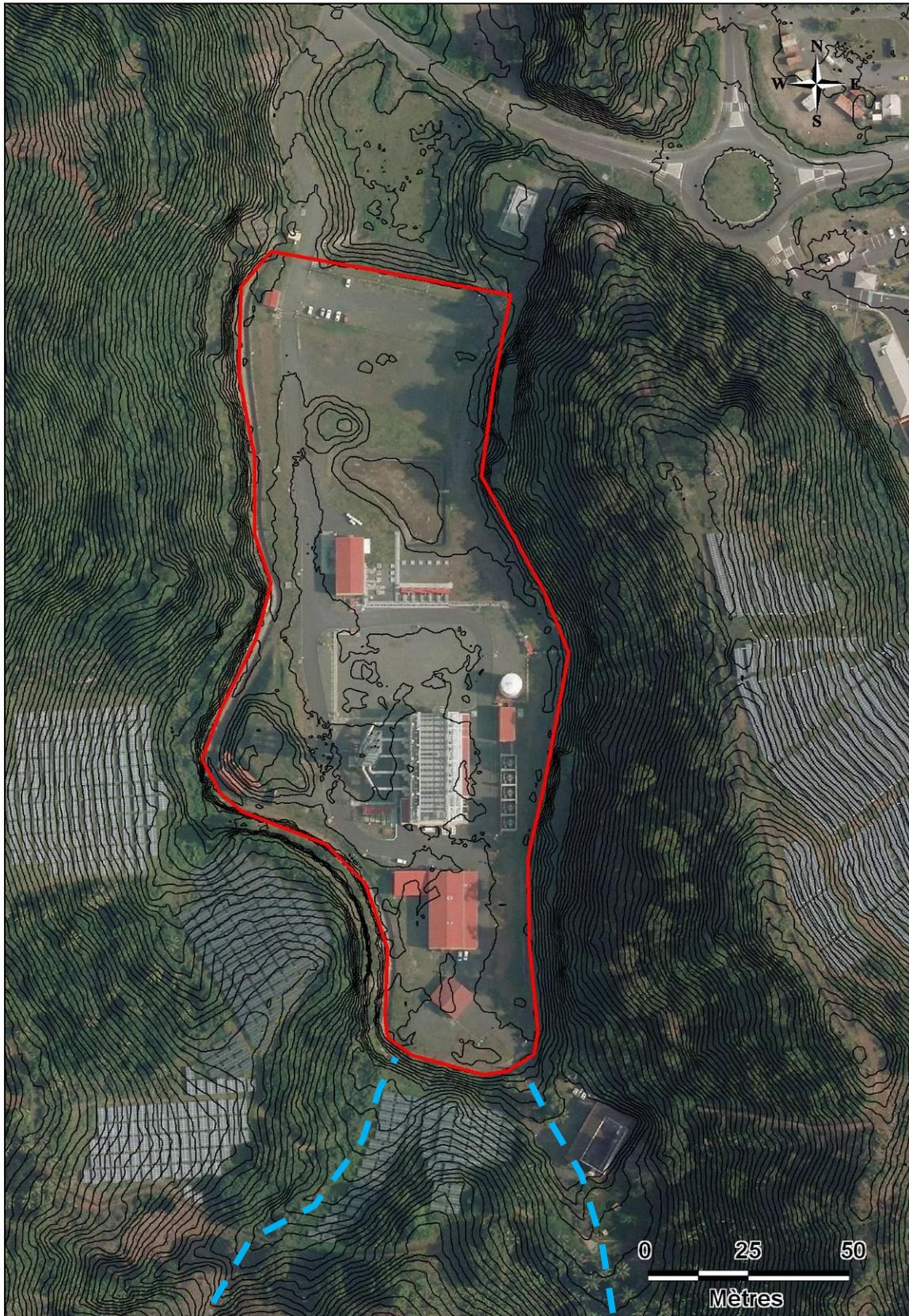
Figure 3 – Morphologie du site et localisation des axes de ravine en amont du site. Courbes de niveau 1 m. Fond orthophotos de l'IGN de 2012. Le bassin d'écrêtement n'était pas encore construit à la date de cette photographie aérienne.
