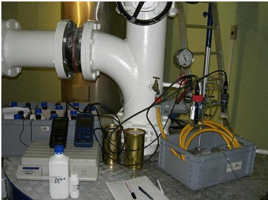
*Illustration 26 : Système de mesure des paramètres in situ et de prélèvement (secteur de la Hardt)*
