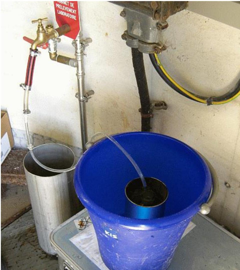
Illustration 60 : Prise de l'échantillon de CFC (CFC11, CFC12, CFC113) et du SF<sub>6</sub>
