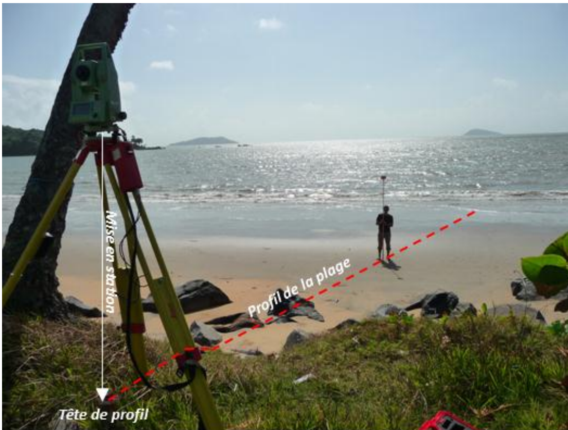
Figure 9 - Mise en place du tachéomètre pour lever un profil de plage (Station n°10)
