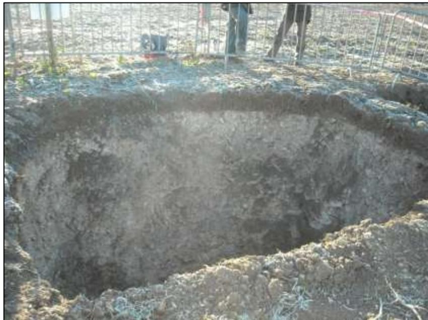
Figure 26 : Photo d'un fontis survenu à Esquerdes en 2010 (BRGM)
