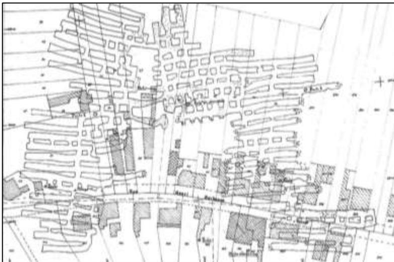
Figure 15 : Exploitation en galeries filantes à Petite-Forêt dans le Nord (Bivert, 1988)
