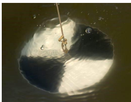
Illustration 2 : Disque de Secchi (utilisation in situ).
