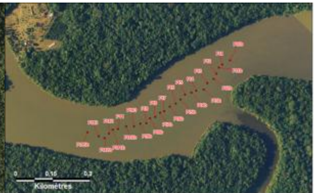
Illustration 24 : Profil de turbidité réalisé sur l'Approuague, le 15 mars 2012
