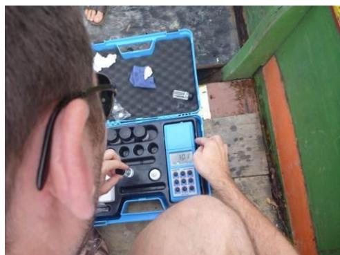
Illustration 3 : Principe et appareil de mesure turbidimètre. Exemple avec le modèle HANNA Instrument.
