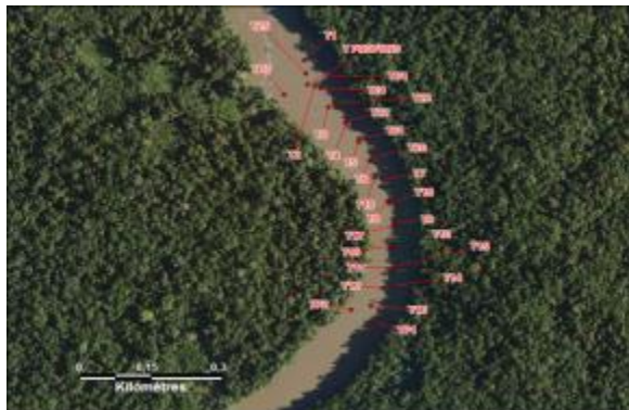
Illustration 23 : Profil de turbidité réalisé sur la Mana, le 14 mars 2012
