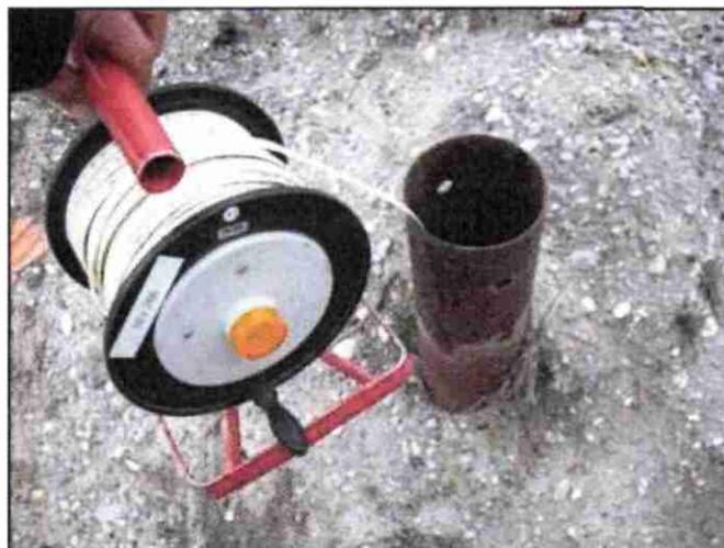
Figure 20 : Exemple de mesure de niveau d'eau sur un piézomètre avec une sonde électrique manuelle
