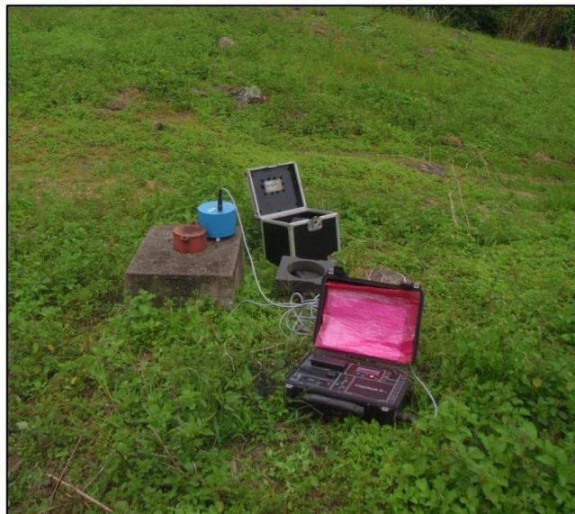
*Figure 9 : Dispositif H/V mise en œuvre sur les différents secteurs de Grand-Ilet
