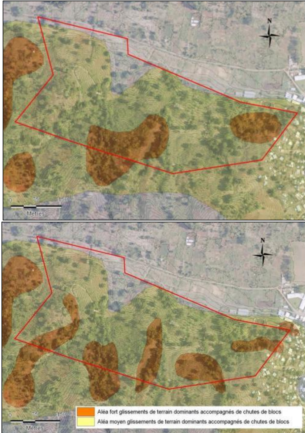
Figure 21 – En haut, extrait de l'atlas des aléas de la commune de Dembéné. En bas, cartographie de l'aléa mouvements de terrain d'après le présent avis. Fond orthophotos IGN. Courbes de niveau 1 m.
