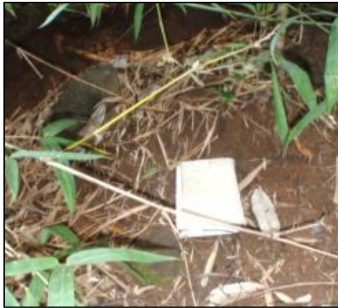
Figure 7 – Colluvions à blocs décimétriques de basalte compris dans une matrice brun-rougeâtre. Photo b de la Figure 10
