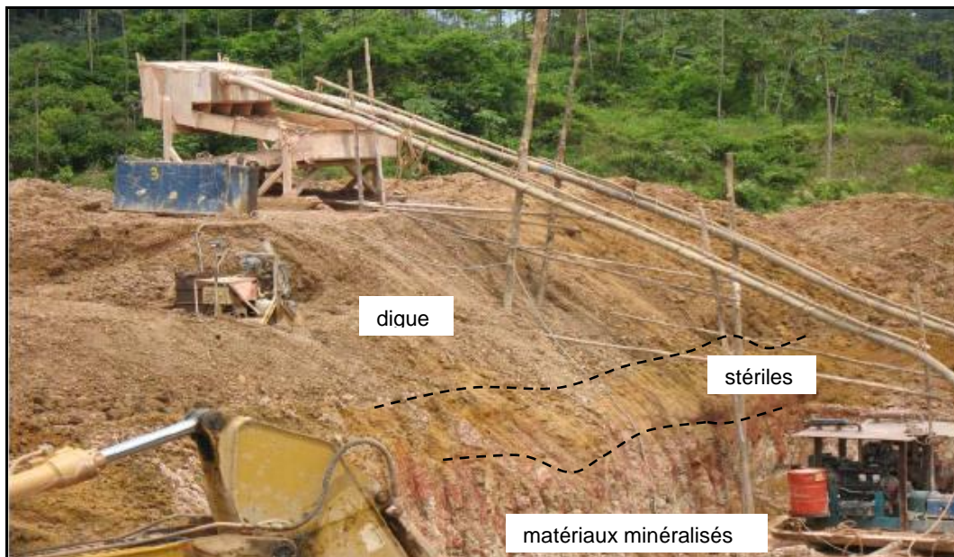
Figure 7 : photo illustrant la coupe type du terrain au niveau d'une barranque (en cours d'exploitation avec double table).
