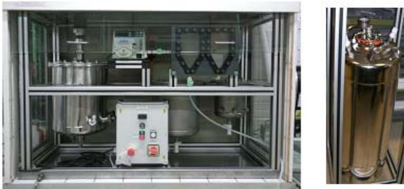
Figure 17 : Photographie de l'installation de flottation continue.
