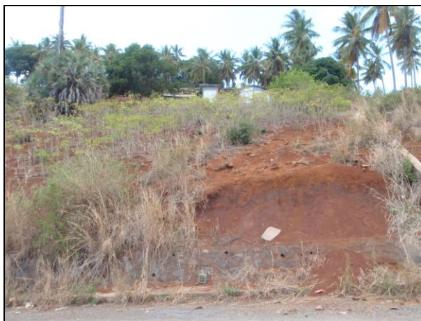
Illustration 5. Eléments fins (matrice prépondérante) et blocs décimétriques (reliques de lave basaltique) caractérisent les colluvions latéritiques composant le sol au droit du site. Photos BRGM
