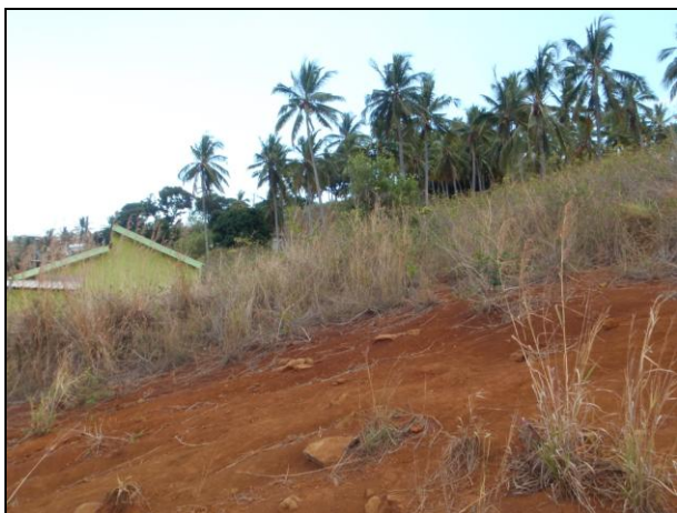
Illustration 5. Eléments fins (matrice prépondérante) et blocs décimétriques (reliques de lave basaltique) caractérisent les colluvions latéritiques composant le sol au droit du site. Photos BRGM
