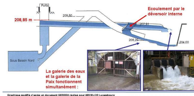
Illustration 37 : Illustration schématique du dispositif de débordement du réservoir Nord
