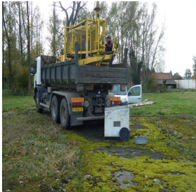
Illustration 18 - Mesure piézométrique à -234,8 m dans le PP1 de Wallers (59), concession renoncée d'Anzin.
