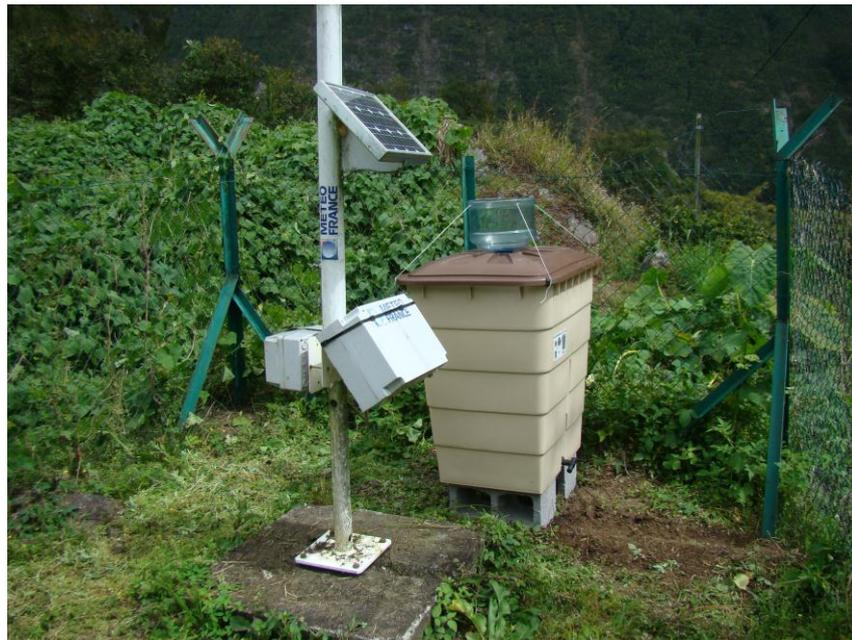
Figure 6 : Collecteur d'eau de pluie de Grand Ilet et pluviomètre MétéoFrance
