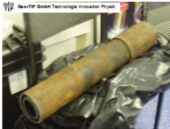
Figure 13 – Double tubage en acier avec espace annulaire sous vide dont les propriétés mécaniques sont étudiées par le projet GenSys (d'après W. Kessels (16))
