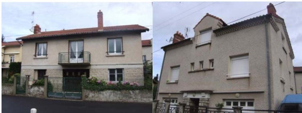
*Figure 23 - Exemples de maisons individuelles construites en maçonnerie porteuse datant de la période 1950-1980 (photos BRGM)*
