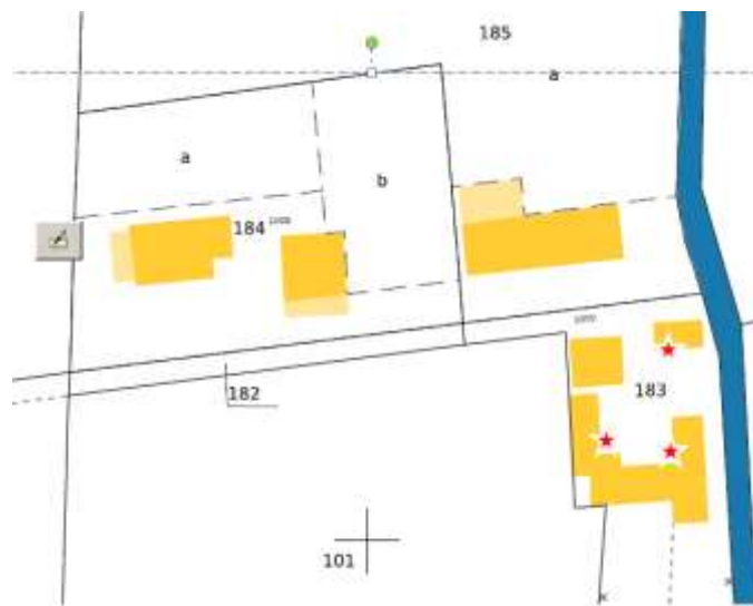
Figure 15 : Parcellaire de la ferme des Grandes Hemmes (extrait). Les étoiles indiquent les façades où des fissures ont été observées
