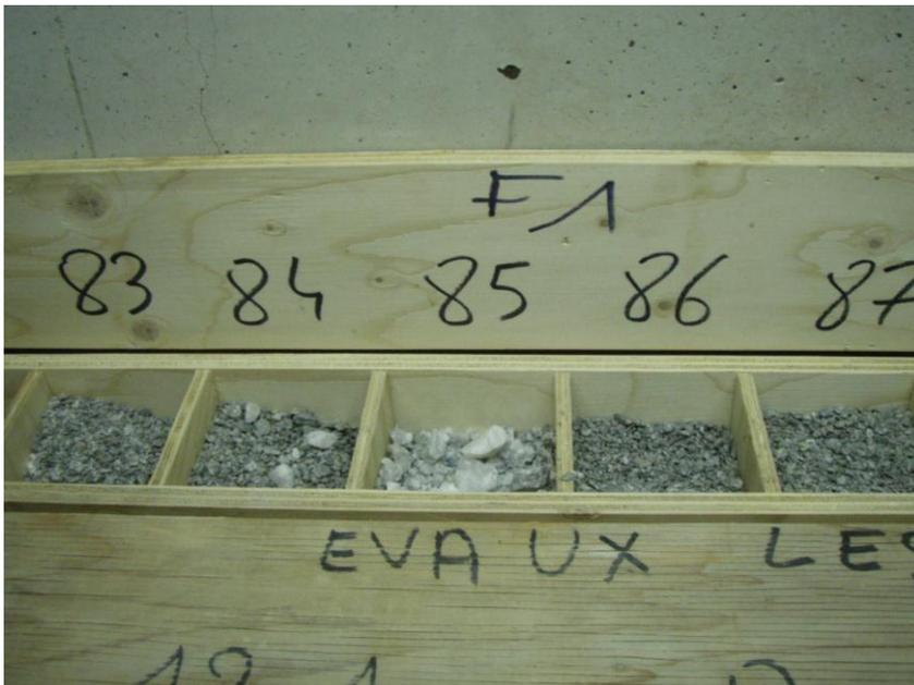
Illustration 36 : Cuttings du forage F1 conservés à Evaux-les-Bains : mise en évidence d’un passage de quartz correspondant à une venue d’eau (Photo Brgm)
