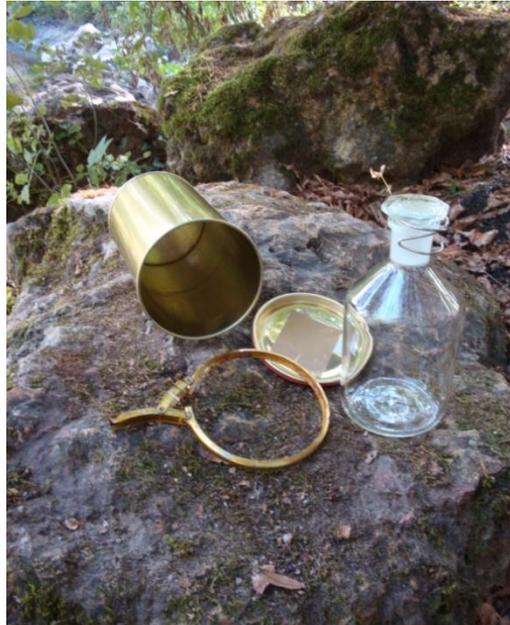
Illustration 71 : Système de prélèvement utilisé pour les CFC et SF<sub>6</sub>.
