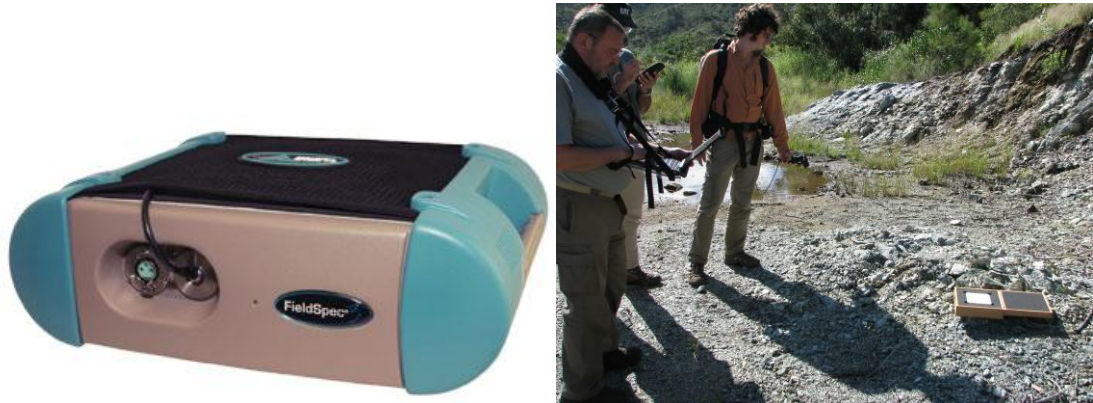
Figure 6 : Spectroradiomètre ASD FieldSpec® 3 et son utilisation en lumière naturelle sur le terrain.
