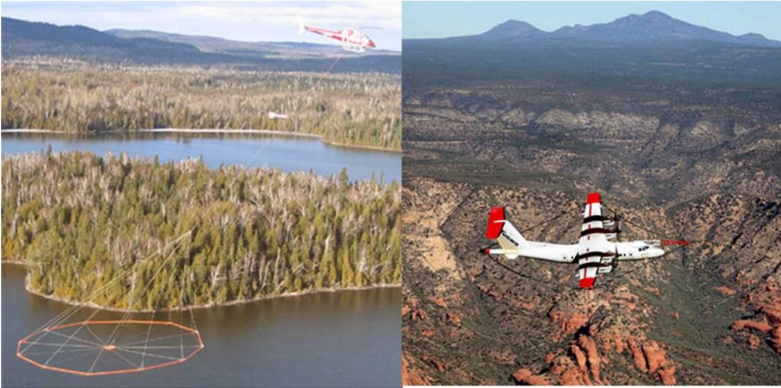
*Illustration 45 : Systèmes VTEM de Geotech Ltd. (à gauche) et MegaTEM développé par Fugro (à droite)*
