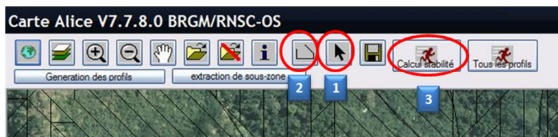
figure 11 : choix d'un profil pour des calculs de stabilité
