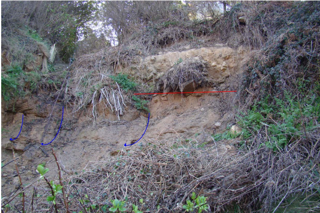
Photo 3 : Différence de lithologie signalée en rouge et écoulements d'eau (en bleu)
