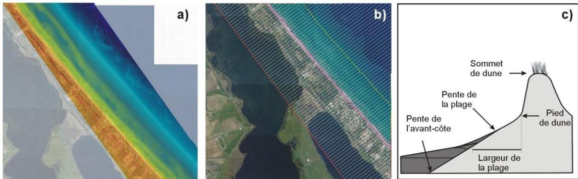
Illustration 8 – Utilisation du levé Lidar pour le calcul des variables morphologiques : a) extrait du modèle numérique de terrain ; b) discrétisation du littoral tous les 50 m et ; c) variables morphologiques calculées.
