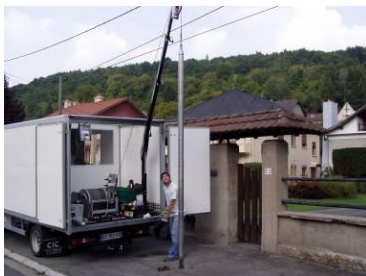
Illustration 86 - Forage 185 : Introduction du sonar - visualisation de la cavité noyée en 3D.
