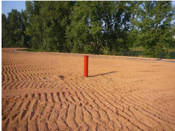
Illustration 229 - Piézomètre TGTi1, Triangle de Marienau, Morsbach (57).
