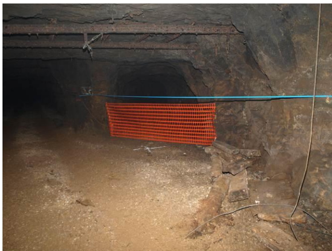
Illustration 199 - Filet de balisage et ligne généphonique posés dans les galeries d'Ottange (57).
