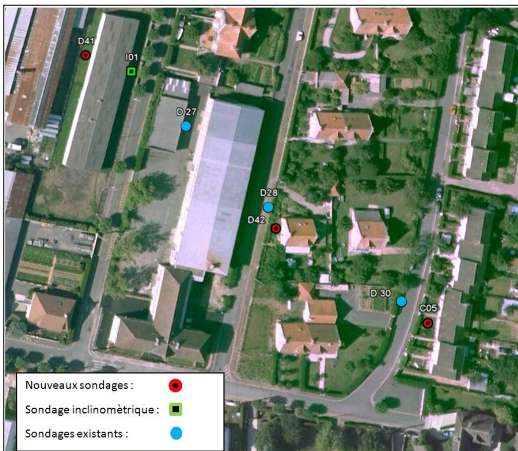
Illustration 142 - Localisation des forages complémentaires à Saint-Martin-de-Fontenay (14).
