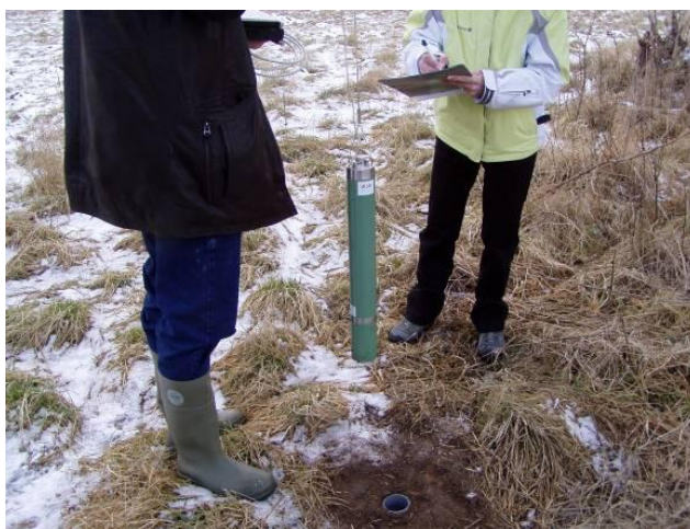
Illustration 120 - Mesure du radon : Mise en place de la sonde BARASOL au point « RAD Porcelette » à Porcelette (57).
