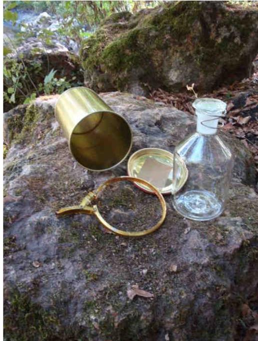
Illustration 17 : Système de prélèvement utilisé pour les CFC et SF<sub>6</sub>
