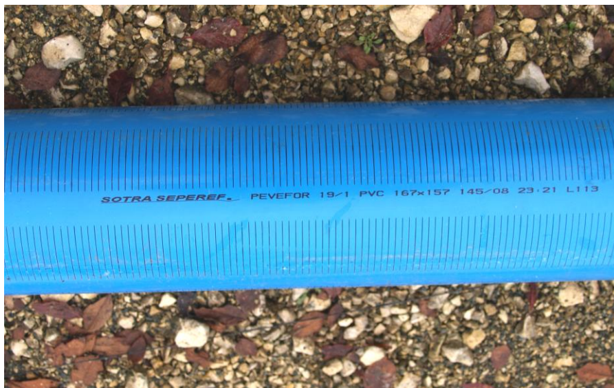
Illustration 8 : Détail de la crépine PVC 6" (157 – 167 mm)
