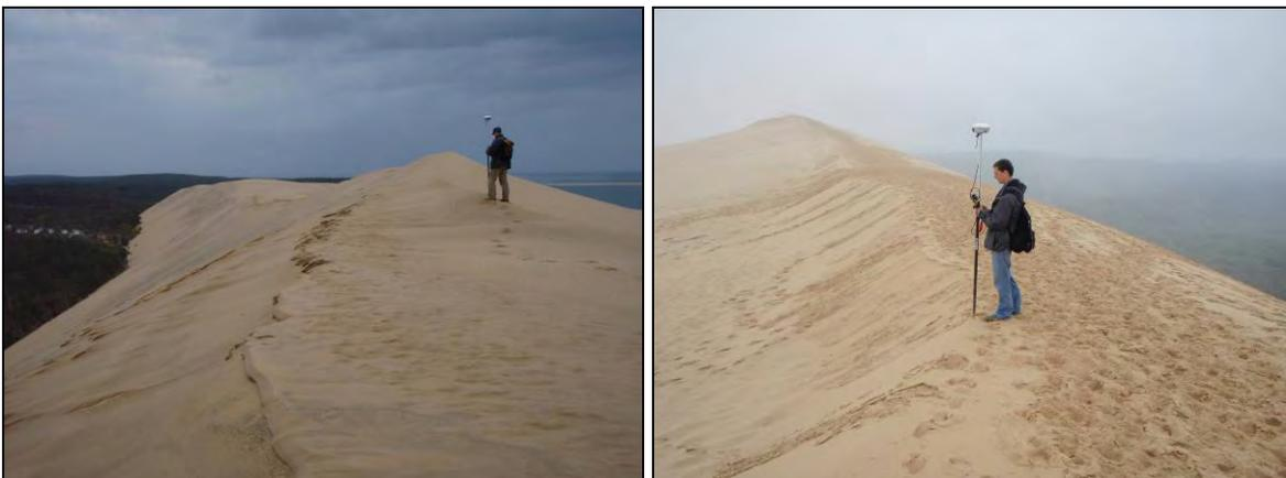
Figure 6 : Levés au DGPS de la ligne de crête de la Dune du Pilat
