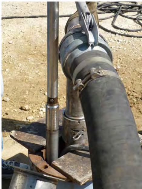
Illustration 68 : Sortie du préleveur, passage à proximité de la pompe et sa colonne d'exhaure en dynamique
