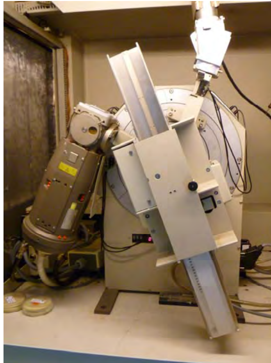
b) Le cœur du diffractomètre (générateur de rayon X, porte-échantillon, etc.).
