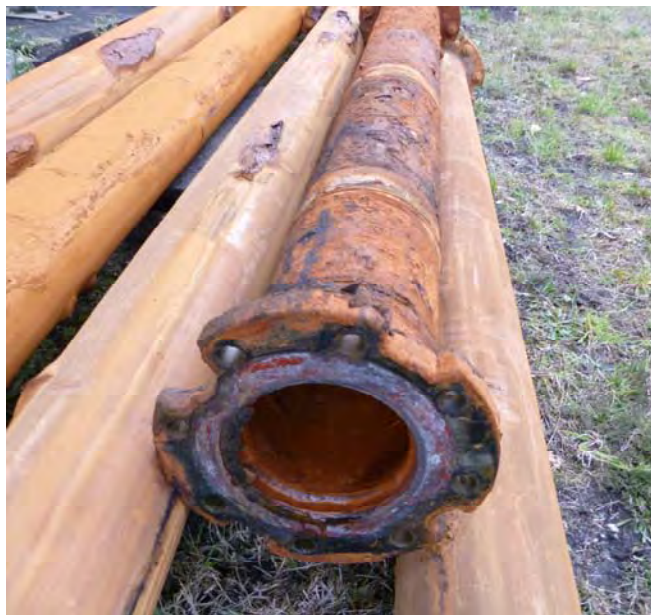
Illustration 73 : Etat du haut de la colonne d'exhaure (Encroûtements, perforations de la colonne en acier).
