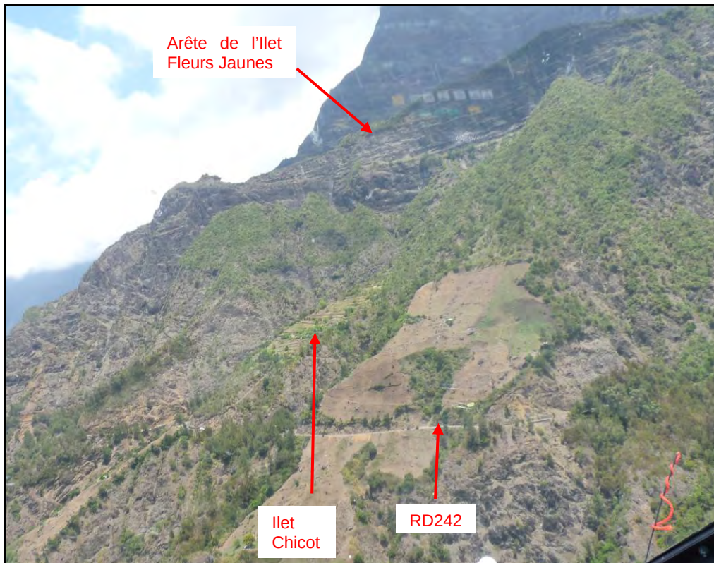
Figure 23 : Zone potentielle de glissement en masse, sous l'arête de l'Ilet Fleurs Jaunes
