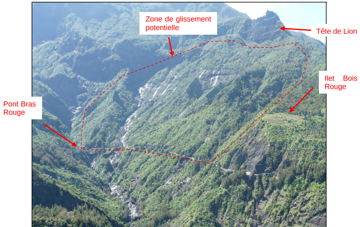
Figure 22 : Zone potentielle de glissement en masse en rive gauche de Bras Rouge, sur intrusion magmatique
