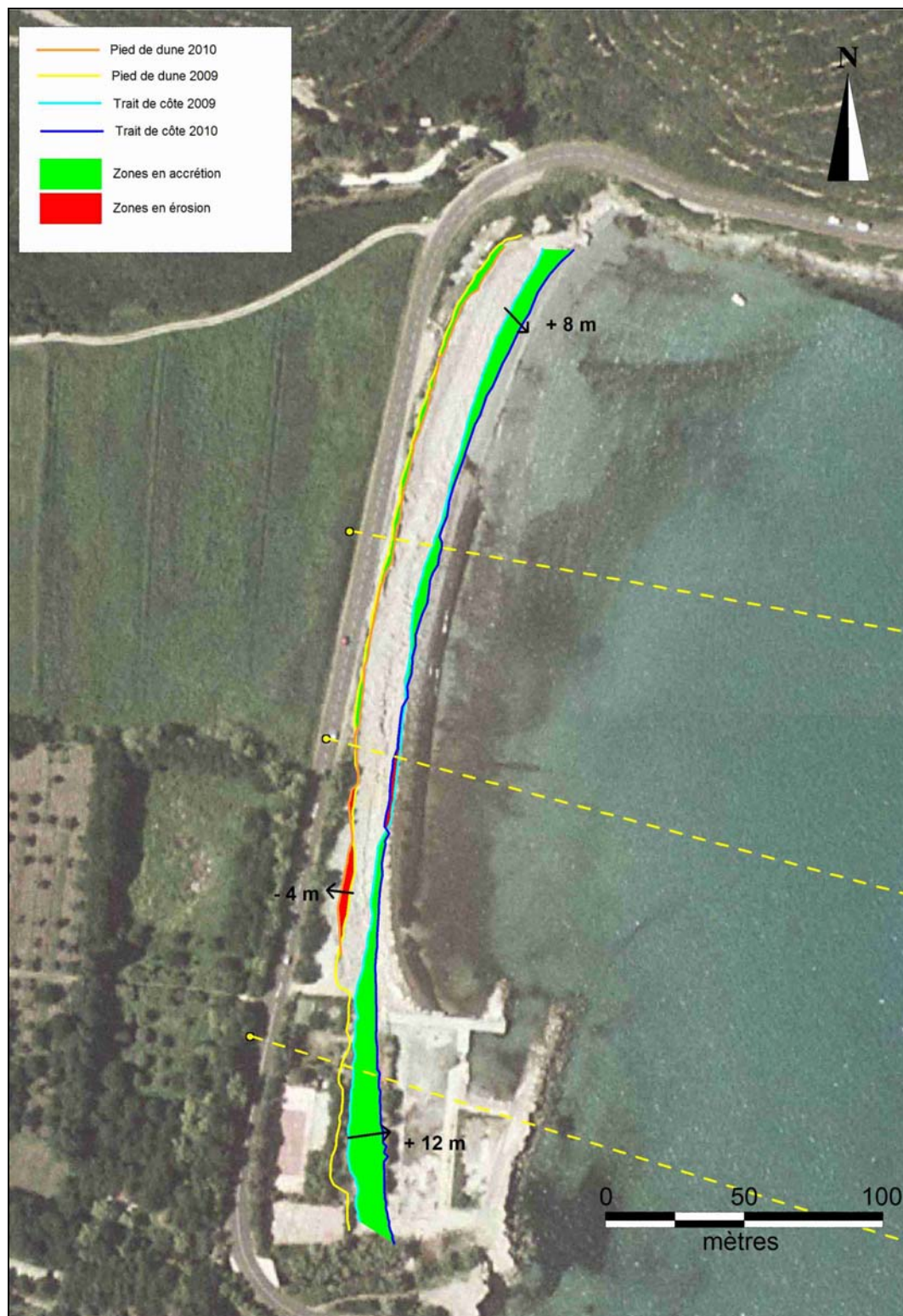
Illustration 28 – Site de Porticciolo, levé DGPS – Comparaison des levés 2009 et 2010 (fond BD-Ortho IGN, 2002).
