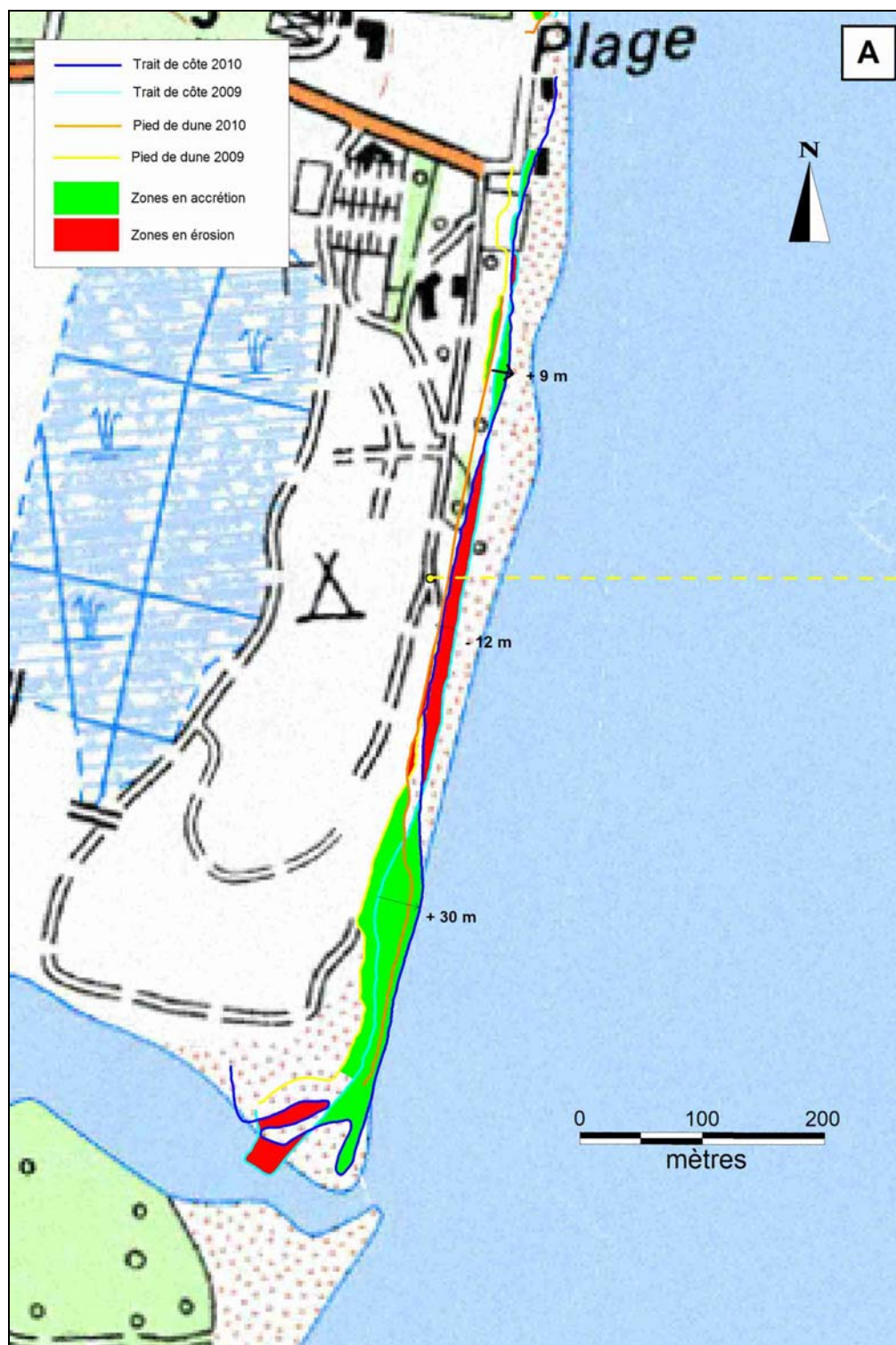
Illustration 14 – Site du Tavignano, levés DGPS du 24/06/2009 et du 28/09/2010 : zoom sur la zone de l'embouchure du Tavignano (secteur A). Les chiffres correspondent aux taux de recul ou avancée entre 2009 et 2010 (© IGN SCAN 25).
