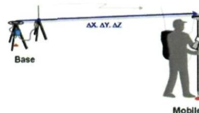
> **Un récepteur + un réseau d'antennes GPS permanentes**
