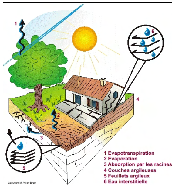
fig. 1 : illustration du mécanisme de dessiccation
