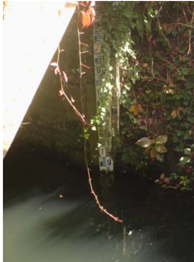
Illustration 15 : Echelle limnimétrique de la station de jaugeage de Pardailan
