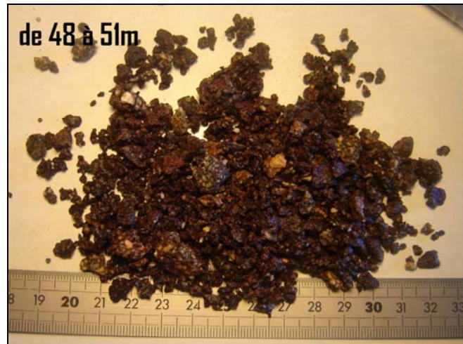
Illustration 15 : Fragments sains entre 48 et 51 m de profondeur (NB : cuttings humides d'où la couleur plus foncée)
