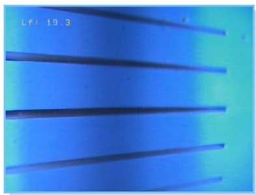
Tubes crépinés en PVC diamètre 180 mm
