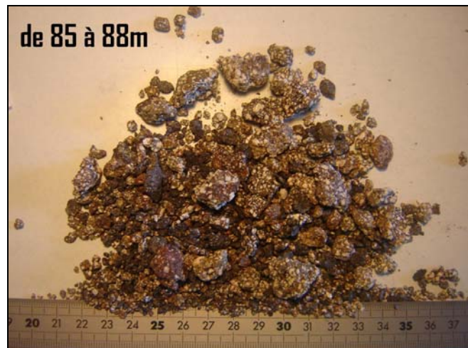
Illustration 16 : Fragments clairs et friables entre 85 et 88 m de profondeur
