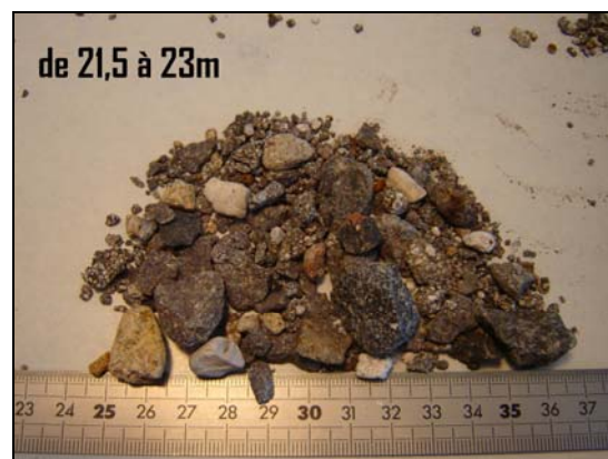
Illustration 9 : Cuttings hétérogènes de 21,5 à 23 m
