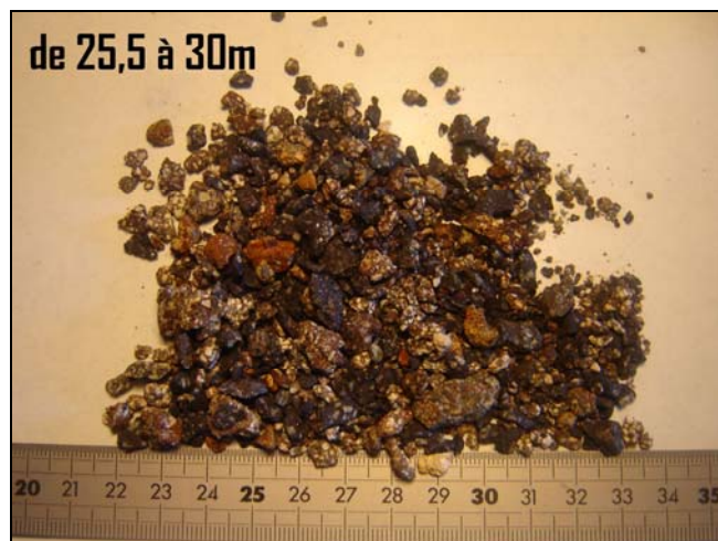
Illustration 14 : Mélange de fragments laviques sains et altérés (cuttings de 25,5 à 30 m)
