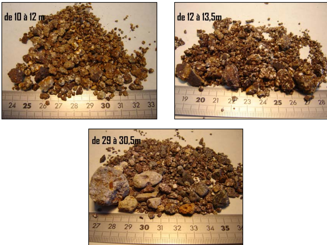
Illustration 8 : Cuttings de roche altérée (de 10 à 30m)
