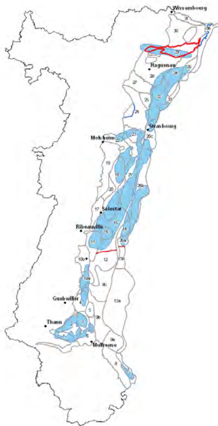
Illustration 8 : secteurs délimités à l'aide du découpage des zones de nappes sub-affleurantes et les limites superficielles de bassins versants
