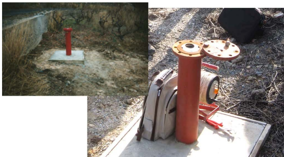
Illustration 3: Vue du piézomètre d'Estagel, en contrebas de la route menant à Mas de Jau (photo haut-gauche) et de l'équipement installé à l'intérieur du tubage (photo bas-droite).
