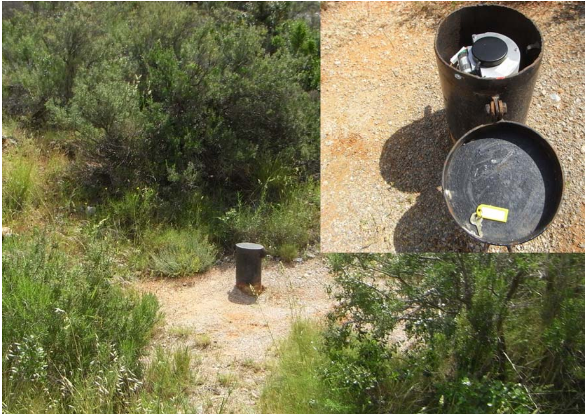
Illustration 7 : Vue du piézomètre P107 et de son équipement.
